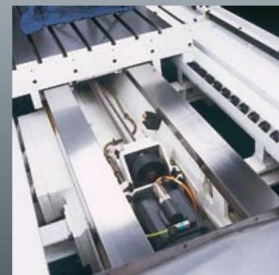
► Aufgrund der präzise definierten und konstanten Klemmung der Führung wird eine stabile und exakt definierte Abstand zwischen Bettbahn und Tischsattel erzeugt (Turcite-B beschichtet und speziell geschabt) unabhängig von der Tischbelastung. Slip-Stick-Effekt wird vermieden.
