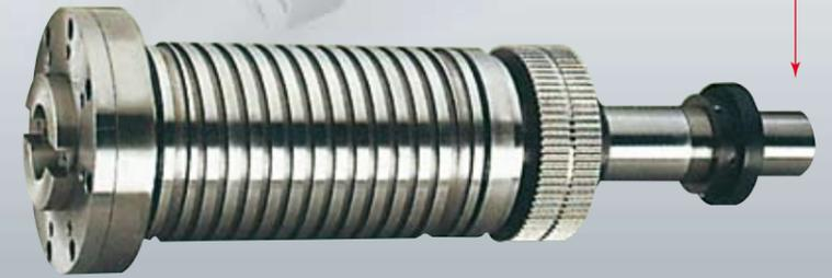
Entfernen Sie den manuellen Standard-Universalfräskopf (oder den optionalen VH-2-Kopf) und es steht Ihnen eine Standard-Horizontal-Spindel ISO50 zur Verfügung für optimales horizontales Bearbeiten. Der Arbeitsraum vergrößert sich um rund 500 mm, so dass auch Bearbeitung am Winkel und bohrwerksähnliche Bearbeitung durchgeführt werden kann.
