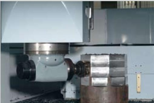
Portalfräsmaschinen zur 5 Seitenbearbeitung mit automatisch
