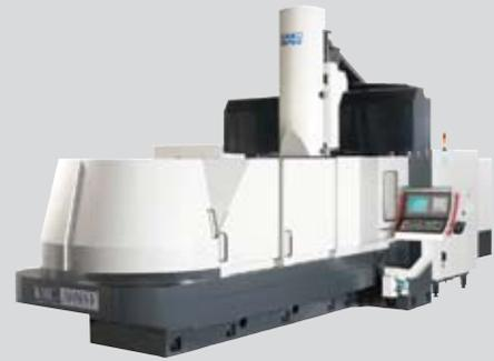
Portalfräsmaschinen zur 3-Achs-Bearbeitung mit Vertikalaus-
