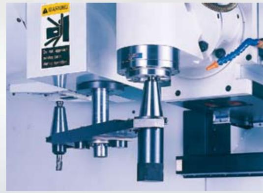
Vertikaler Werkzeugwechsel mit 24 Stationen, Schwenkartyp.
