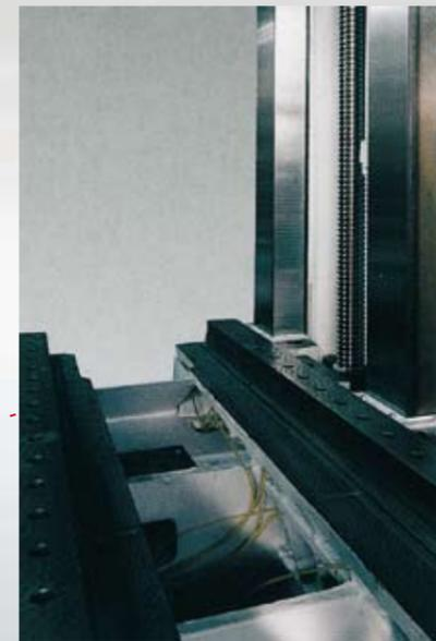
► Die großzügig dimensionierten Führungsbahnen sichern eine hohe permanente Präzision, unterstützt durch spezialgehärtete vertikale und horizontale Führungsbahnen am Ständer und am Frässlitten; die Gegenführungen sind mit Turcite-B beschichtet. Die Konsole hat eine sehr lange Auflagefläche in der Vertikalachse für hohe Stabilität und um ein Abkippen des Auslegers zu vermeiden.
