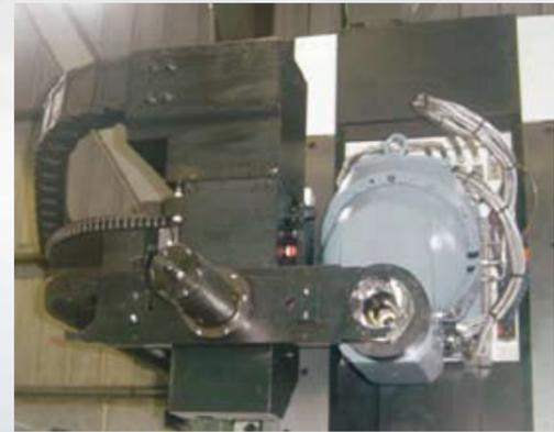
Horizontaler Werkzeugwechsel mit 32, 40 oder 60 Stationen, Schienen-Schwenkartyp.
