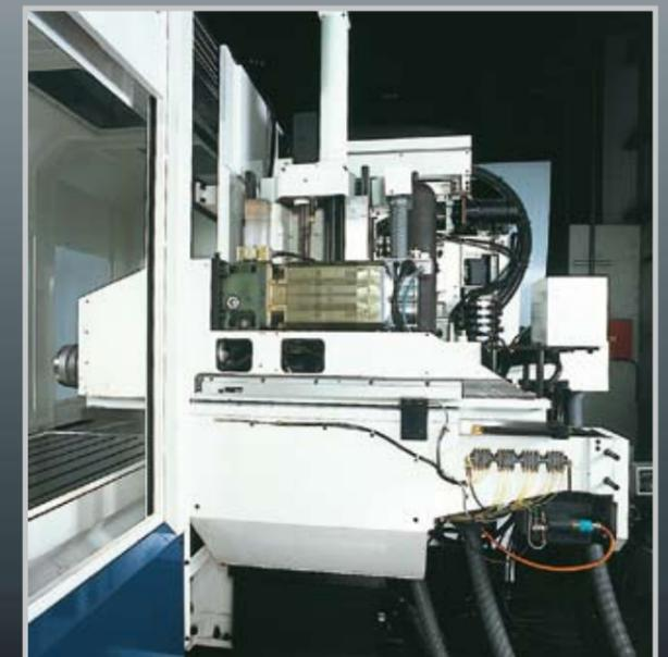
Ein Siemens-Spindelmotor mit 17/25 kW in Verbindung mit einem ZF-Getriebe stellt ein Drehmoment von bis zu 1000 Nm zur Verfügung. Die komplette Gusskonstruktion in Verbindung mit groß dimensionierten Flachführungen in allen Achsen gewährleistet Stabilität und exzellentes Dämpfungsverhalten.
