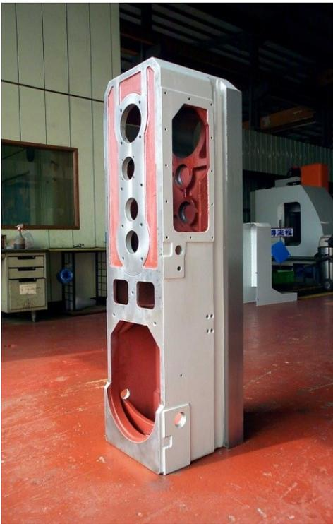
Sowohl der Maschinenunterbau als auch der Maschinenständer sind jeweils aus einem Stück gegossen und für höchste Stabilität stark verrippt.
