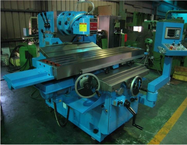
**Bedienerfreundlich:** Anordnung aller Handräder an der Maschinenvorderseite. Somit ist jederzeit eine optimale Sicht des Bedieners auf den Zerspanungsvorgang gewährleistet.
