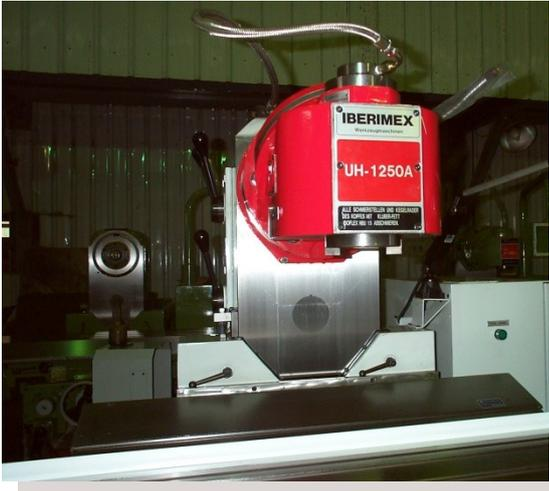
Der serienmäßige Universalkopf ermöglicht jederzeit eine 4-Seitenbearbeitung und das Fräsen von Schrägen in X- und Y-Achse
