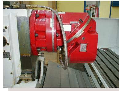
Bei Demontage des Kopfes steht ein SK-50-Horizontalausgang zur Verfügung (Nicht bei Modell U-1000)
